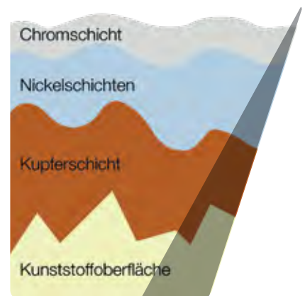
⬆ Schematische Darstellung der Einebnung der Rohteil-Struktur durch die darüber liegenden Schichten
