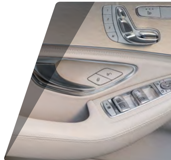
↑ Bauteile in der Türinnenverkleidung der Mercedes-Benz C-Klasse aus verschiedenen Grundmaterialien
