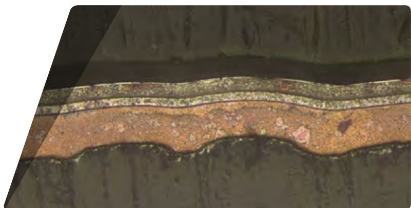
⬆ Der Schliff durch das Bauteil nach der Laserbehandlung zeigt: Der Schichtaufbau wird nicht beeinträchtigt.
