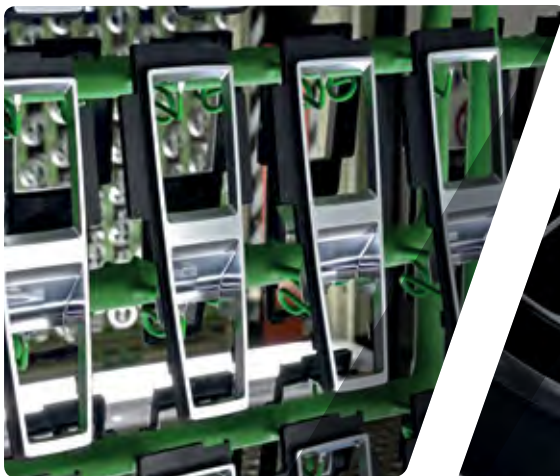
↓ Blende für den Wahlganghebel des A8 auf einem Galvanik-Warenträger und im Verbau →
